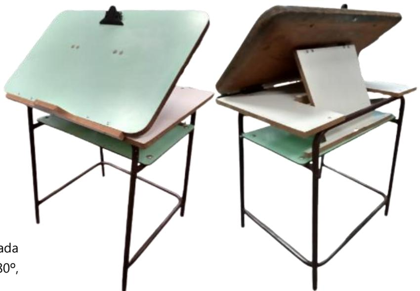
**Figura 1.** Mesa escolar infantil adaptada com tampo inclinável em 0°, 45°, 90° e 180°, além de fixador de folhas e batente.
